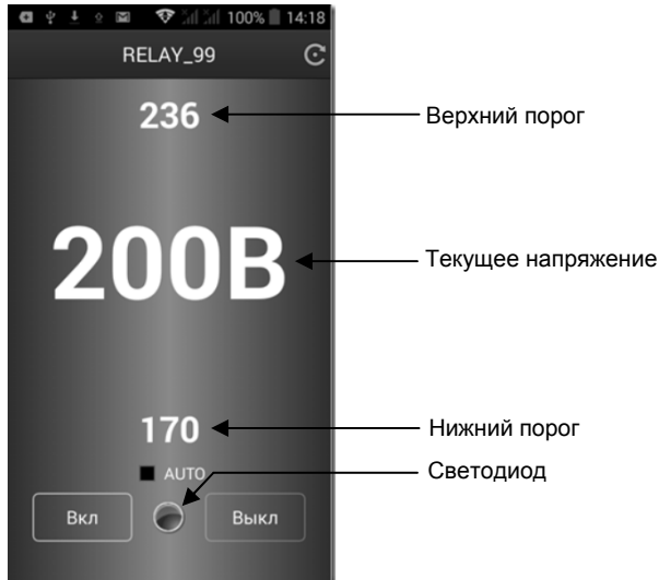
Рисунок 3 - основной экран приложения после установки соединения смартфона с изделием.
