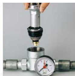
5. Потяните колпачок и вытащите мембрану.
