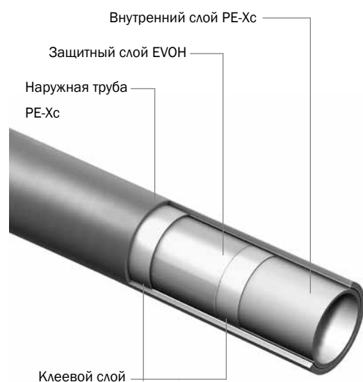
Структура трубы TECEflex PE-Xc 5S
