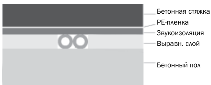
Пример прокладки трубопровода TECEflex в полу
