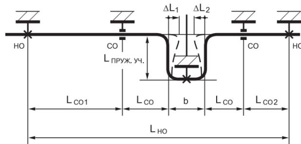
Компенсацию тепловых удлинений решают конструктивно, используя углы поворота, скользящие и неподвижные опоры, а также готовые компенсаторы. В неподвижных опорах труба жёстко крепится хомутом через резиновую прокладку, а в скользящих опорах фиксаторы позволяют трубе перемещаться в осевом направлении.
