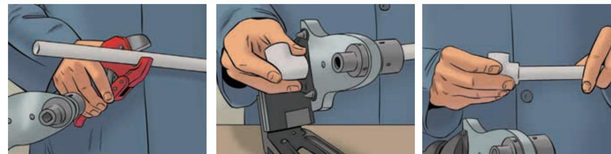
1. На сварочный аппарат устанавливаются насадки соответствующего диаметра, при этом рабочие поверхности насадок должны быть обезжирены ацетоном или водным раствором спирта. В случаях налипания на насадки остатков полимеров от предыдущей сварки, необходимо провести очистку рабочих поверхностей.
