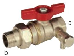
Шаровой кран, никелированный, с красной рукояткой-бабочкой, соединение с внешней /внутренней резьбой, с отводом и сливным краном. Сливной кран на 1/4", за исключением R919SX009, который имеет сливной кран на 3/8".
