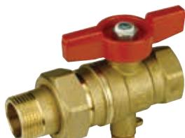
Шаровой кран, не хромированный, с красной рукояткой-бабочкой, соединение с внутренней/внешней резьбой, с отводом и выводом для зонда. Соединение для зонда с внутренней резьбой M10.
