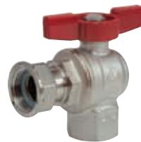
Кран шаровой угловой полнопроходной с отводом, с красной рукояткой-бабочкой, с отводом с накидной гайкой для подключения счетчиков, хромированный.
