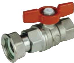
Шаровой кран, хромированный, для счётчика, с красной рукояткой-бабочкой, соединение с внутренней/внутренней резьбой с телескопическим отводом и накидной гайкой. Стандартный проход.
