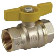
Шаровой кран, никелированный, с рукояткой-бабочкой, соединение с внутренней резьбой. Полнопроходный. Усиленная серия.
