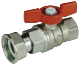
Шаровой кран, хромированный, для счётчика, с красной рукояткой-бабочкой, соединение с внутренней/внутренней резьбой с телескопическим отводом и накидной гайкой. Стандартный проход.
