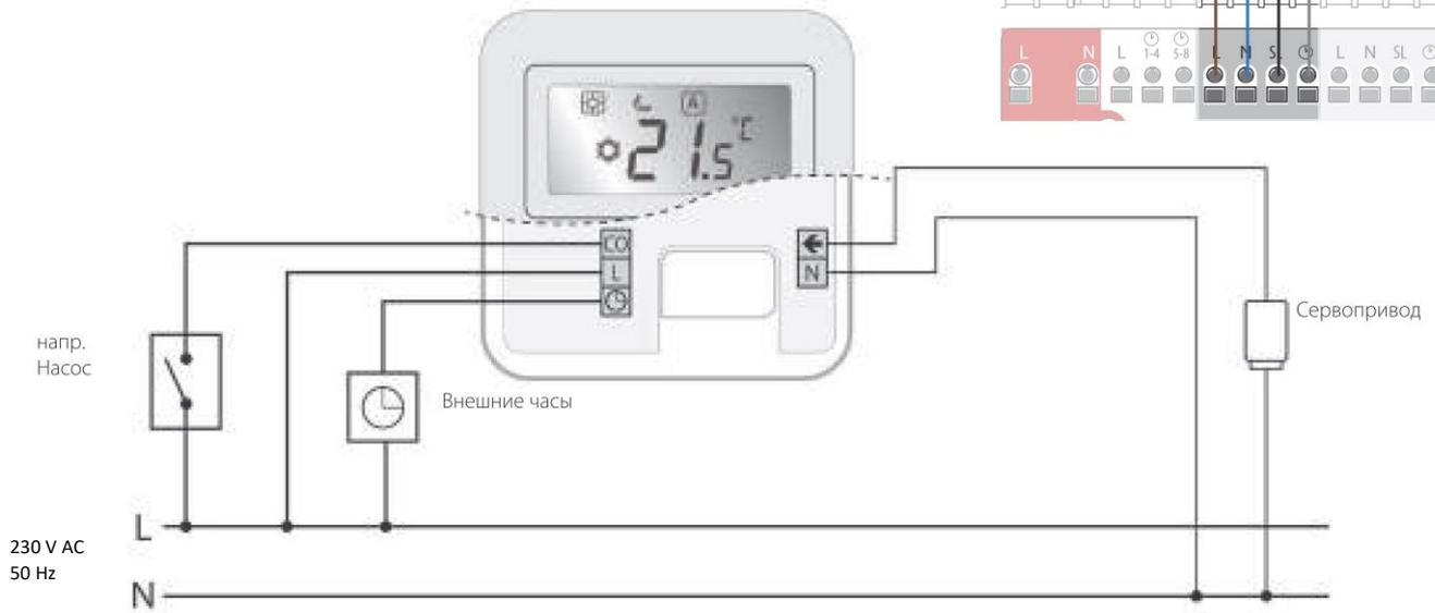
Продемонстрированная схема не заменяет проект установки систем отопления и наводится исключительно в качестве примера!
