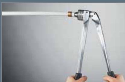
**Нанизывание пресс-втулки на трубу и расширение трубы**
