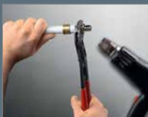
Соединение можно разобрать, разогрев его до 180 °С техническим феном.
