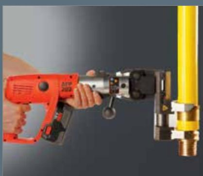
Для монтажа труб диаметром 40–63 мм пресс-инструментом PMA в качестве приводного механизма необходим стандартный пресс-инструмент с усилием прессования не менее 32 кН, но не более 38 кН.
