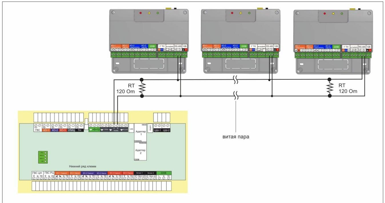
**Примечание:** В случае использования различных блоков питания для БР и Регулятора при подключении по RS-485 необходимо проводом соединить клеммы “минус основного питания” БР и Регулятора.
