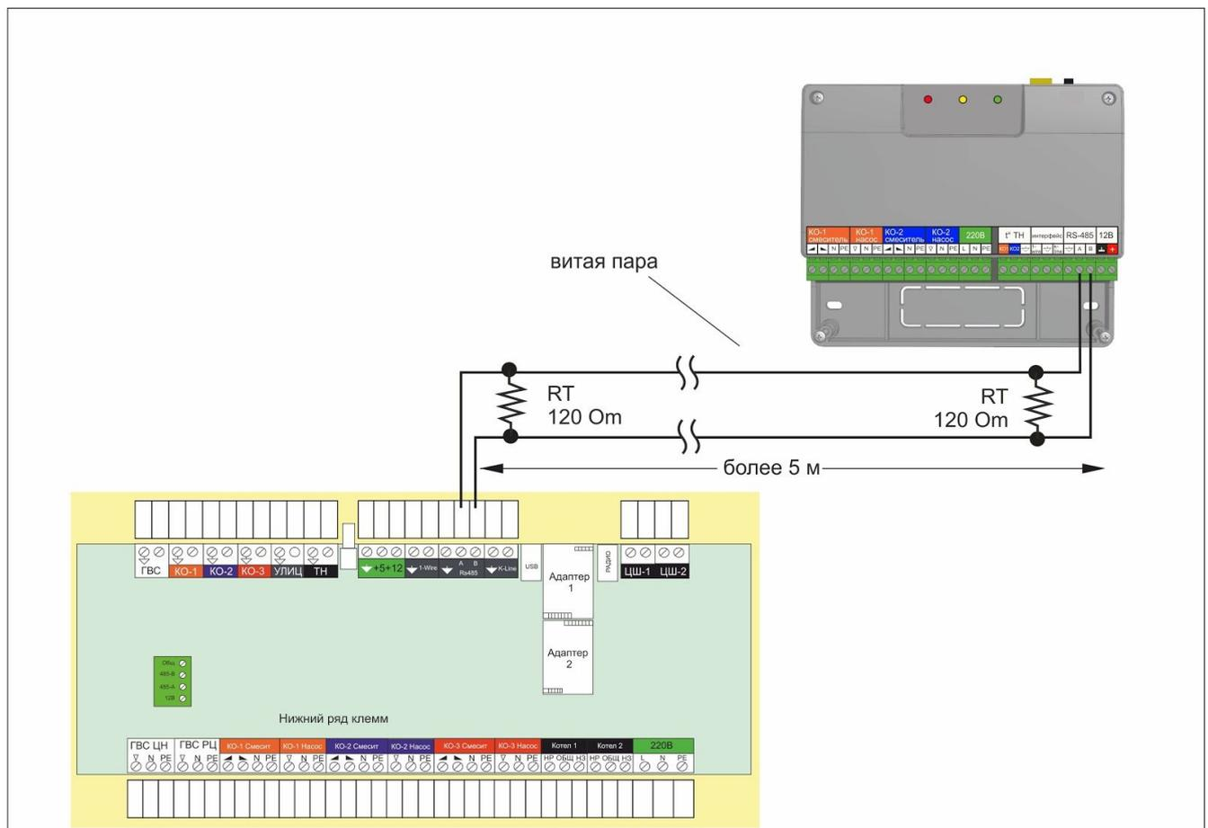
К Регулятору ZONT Climatic 1.3 доступно одновременное подключение 6 (шесть) БР. В случае подключения двух и более блоков расширения к Регулятору рекомендуется использовать внешний блок питания 12 В.
