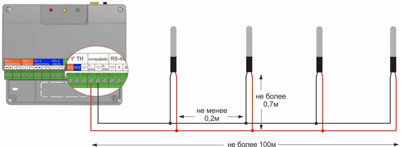
**Примечание:** Производитель оборудования не гарантирует нормальную работу контроллера при использовании неоригинальных датчиков. Оригинальными датчиками считаются датчики с сенсорами производства MAXIM.
