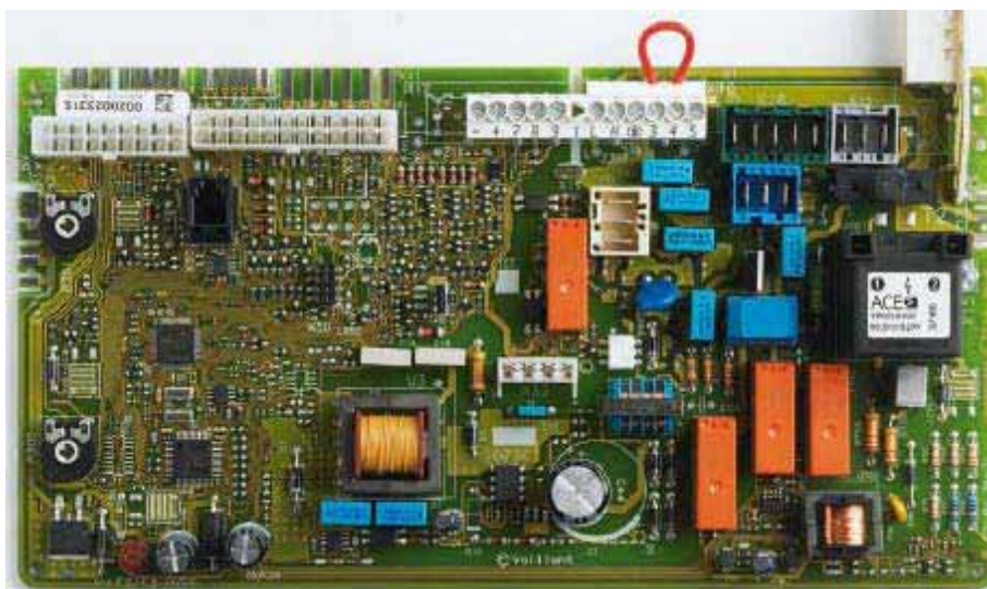
Электронная плата котла
