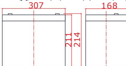
ТЕРМИНАЛЫ ПОД БОЛТ: М6
