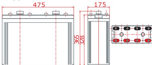
ТЕРМИНАЛЫ ПОД БОЛТ: М8
