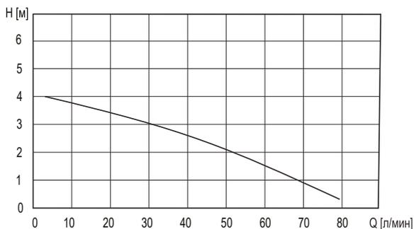
Рис. 1. Гидравлические характеристики.
