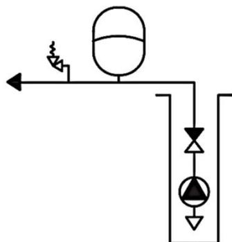
Схема подключения расширительного бака в систему отопления
