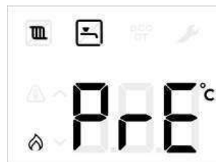
Рис. 19 Индикация подогрева вторичного теплообменника
