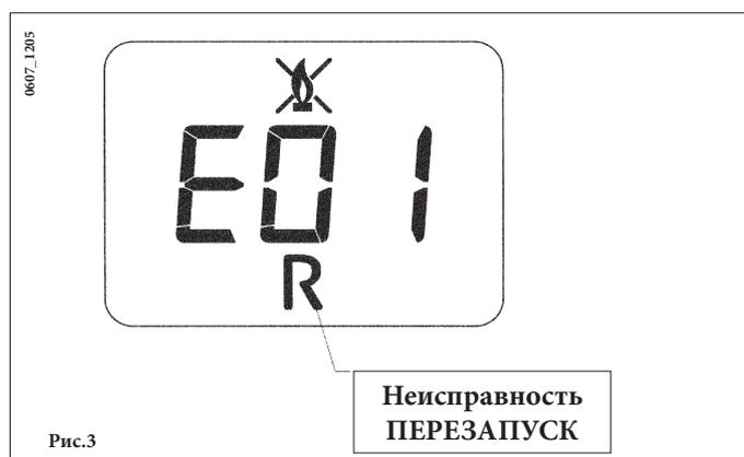
Для перезапуска котла установите переключатель режимов (Рис.2) на 2 сек в положение «R». При повторных срабатываниях данного устройства обратитесь в обслуживающую организацию.
